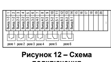
Рисунок 12 – Схема подключения электромагнитных реле прибора TRM136-Р
