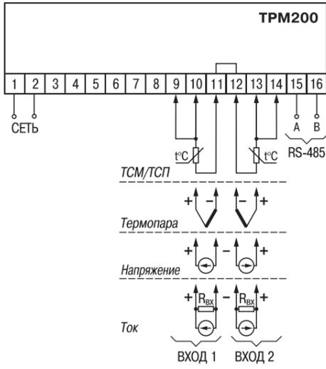
Входы 1 и 2 – универсальные, возможно подключение двух датчиков разного типа.
