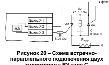
Рисунок 20 – Схема встречно-параллельного подключения двух тиристоров к ВУ типа С
