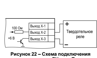
Рисунок 22 – Схема подключения нагрузки к ВУ типа Т
