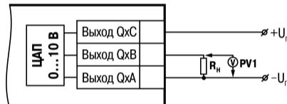
Рисунок 14 – Схема подключения нагрузки к ВЭ типа «У»
