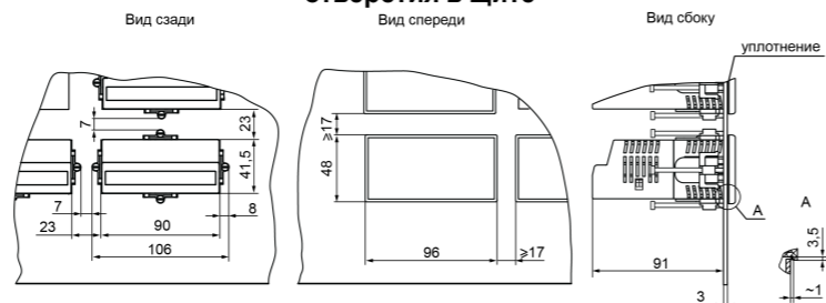
Рисунок 6 – Корпус Щ2 в щите толщиной 3 мм
